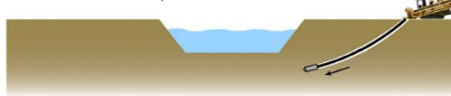
ÉTAPE 1 : Réalisation d'un trou pilote
