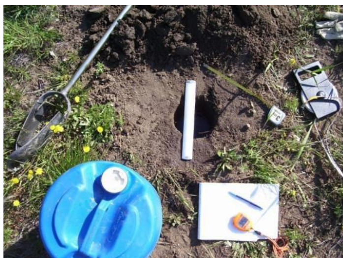
Photo 1 : Exemple de réalisation d'un essai de Porchet.
